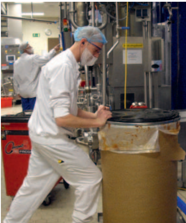
Knelpunt: het verwisselen van een vat caramelsaus; het vat van 265 kg. moet handmatig op de plaats geschoven worden.
