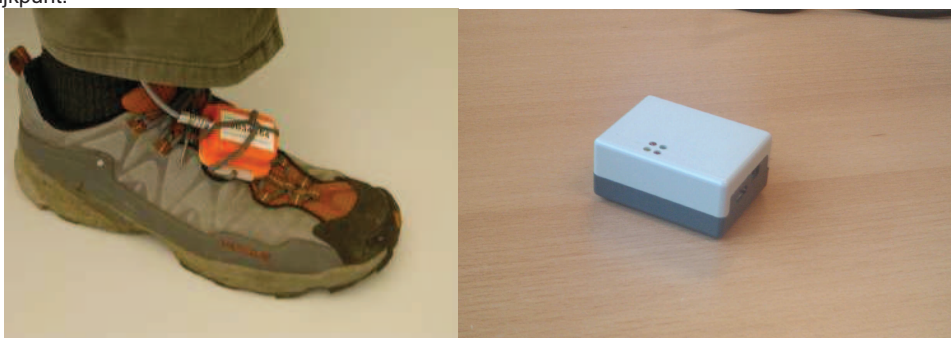
Figuur 6-1 - Voorbeeld van een Xsens IMU sensor (links) en een Inertia Technology IMU sensor (rechts)
