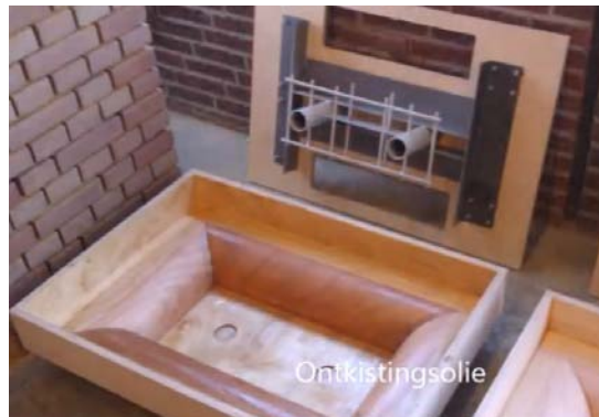
Schuimbeton in de mallen pompen: Opvullen en afvlakken van de onderzijde:
