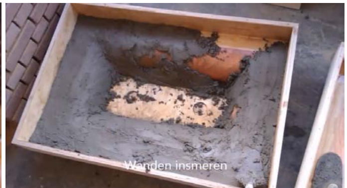
Schuimbeton in de mallen pompen: Opvullen en afvlakken van de onderzijde:
