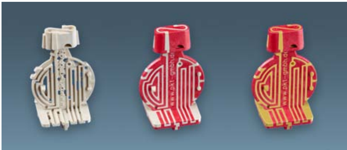
Figuur 16: Eerst kunststof met additief, activeren, dan omspuiten, ten slotte metalliseren
