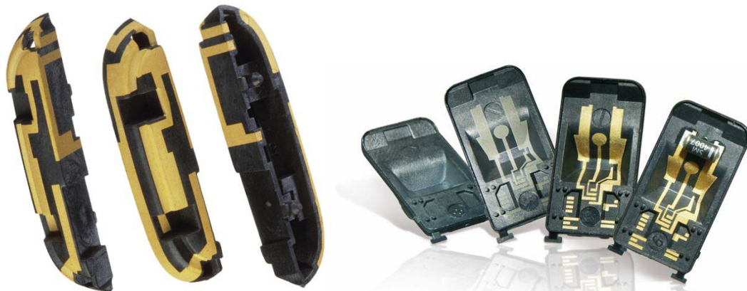
Figuur 14: Antennes mobiele telefoon
