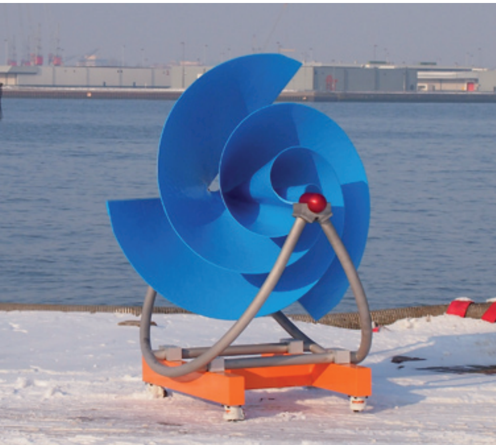
De windturbine Archimedes, ook wel wokkel genoemd, maakt gebruik van kinetische energie van de wind.
