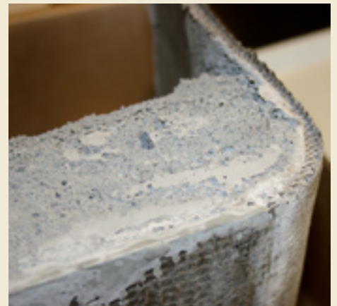
De combinatie van beton, canvas en schuimbeton.
