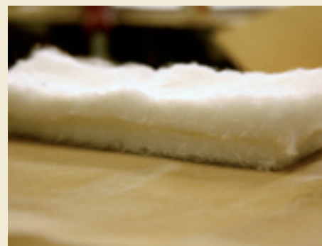
Twee lagen Bluedec, een non-woven doek, geïmpregneerd met aerogel.
