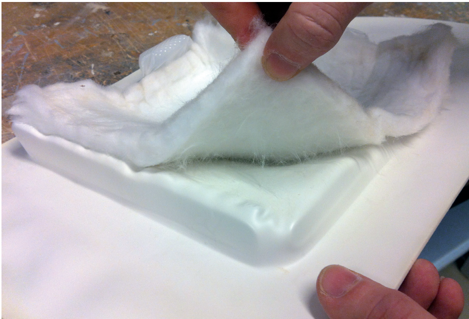
Vacuümvormtest met Bluedec, een hoogwaardig isolatiemateriaal
