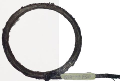
Figuur 11 – Print met radius 50mm en feed 500mm/min
