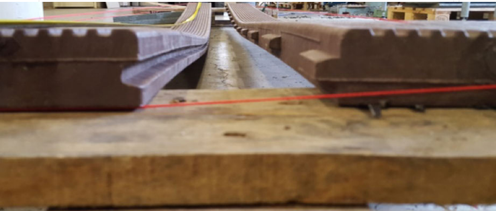
Figuur 35: Steigerplanken van laagwaardig recyclaat buigen makkelijk door.
