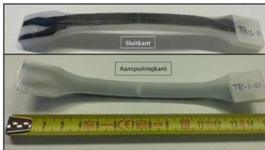
Figuur 30: Niet-symmetrische trekstaafjes met insert.
