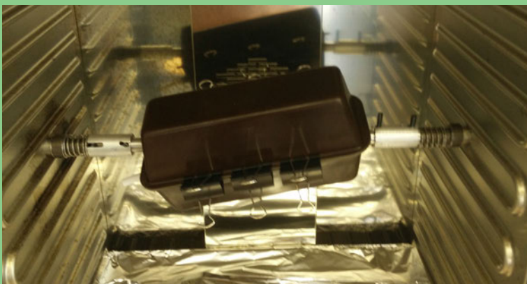
Figuur 40: De labopstelling waarmee proefproducten in een oven gegoten kunnen worden.
