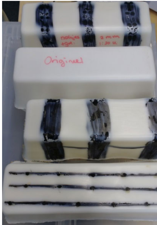
Figuur 41: Verschillende producten, met en zonder vezelversterking, vervaardigd met rotatiegieten
