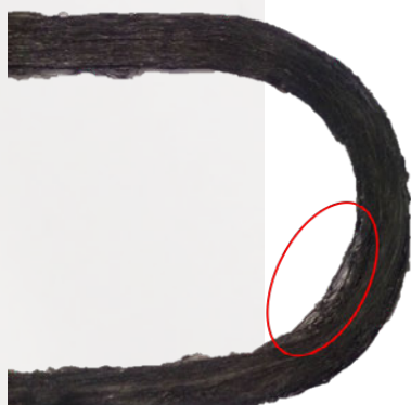
Figuur 13 – Print met radius 25mm en feed 120mm/min
