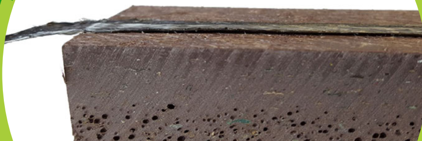
Figuur 37: Detailopname van een gording voorzien van TPC tape.
